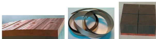
а) Поверхность \text{CuCrZr} теплоотвода б) Припой СТЕМЕТ® 1108 в) W/Cu плитка
