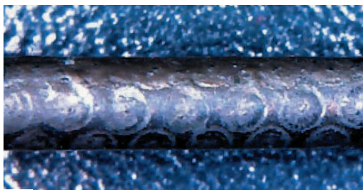
Рис. 2. Поверхность трубки после воздействия лазерными импульсами.
